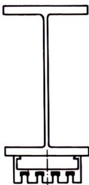
Fig. 3 - Montage sous ailes d'un fer I
